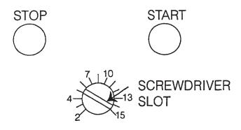
TIMER ADJUSTMENT UNDER SNAP PLUG ON CONTROL PANEL FACE NOTES:
