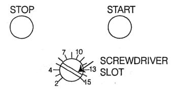
TIMER ADJUSTMENT UNDER SNAP PLUG ON CONTROL PANEL FACE
